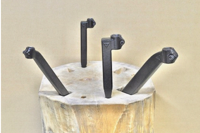
上はソケット式当て金「RT」の支持体の据え付け例です。 左側が「RT16」、右側が「RT24」です。 「RT24」は強度を優先して大きめに作りましたが、 「RT16」は小型作品用に軽快な当て金とした道具です。
